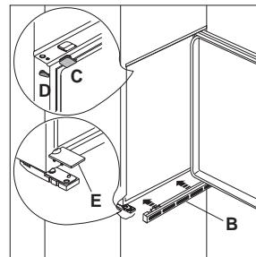
4. Установить вентиляционную решётку (В) и накладку петли (Е), защёлкнув их.
