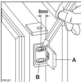
8. Откройте дверь морозильника и шкафа приблизительно на 90°. Вставьте кронштейн (В) в направляющую (А). Удерживайте двери прибора и шкафа вместе и отметьте отверстия, как показано на рисунке. Снимите кронштейны и просверлите отверстия диаметром 2 мм на расстоянии 8 мм от наружной кромки двери. Вновь установите кронштейн на направляющую и закрепите входящими в комплект винтами.
