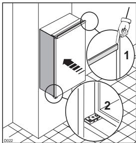
1. Вставить прибор в проём до тех пор, пока верхний стопор не упрёстся в панель мебели.
