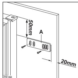
6. Приложите направляющую (А) на внутреннюю сторону двери шкафа, сверху и снизу, как показано на рисунке, и отметьте положение крайних отверстий. Подготовив отверстия, установите направляющую при помощи входящих в комплект винтов.
