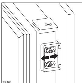
9. Для выравнивания двери шкафа пользуйтесь регулировочными прорезями.
